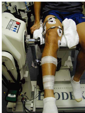
皮膚表面電極貼在四頭肌上紀錄EMG和貼在小腿上作「經皮表面電刺激穴位療法」的情況。
