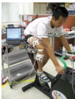
圖1：在5分鐘單車運動過程中，由右腿的8塊肌肉持續記錄表面肌電數據
